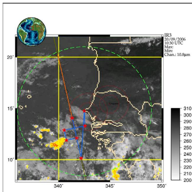
Plan de vol du Falcon 20 (en bleu) sous la trace de CALIPSO/CloudSat (trace en orange) superposé à l'image MSG juste avant le décollage. Le Falcon 20 effectue un vol de 40 minutes sous la trace puis va décrire l'hétérogénéité perpendiculaire à la trace.
